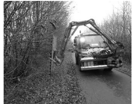
Seitlicher Rückschnitt mit einem Scheren-Aufsatz
